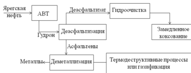
Рис. 4. Схема переработки ярегской нефти
